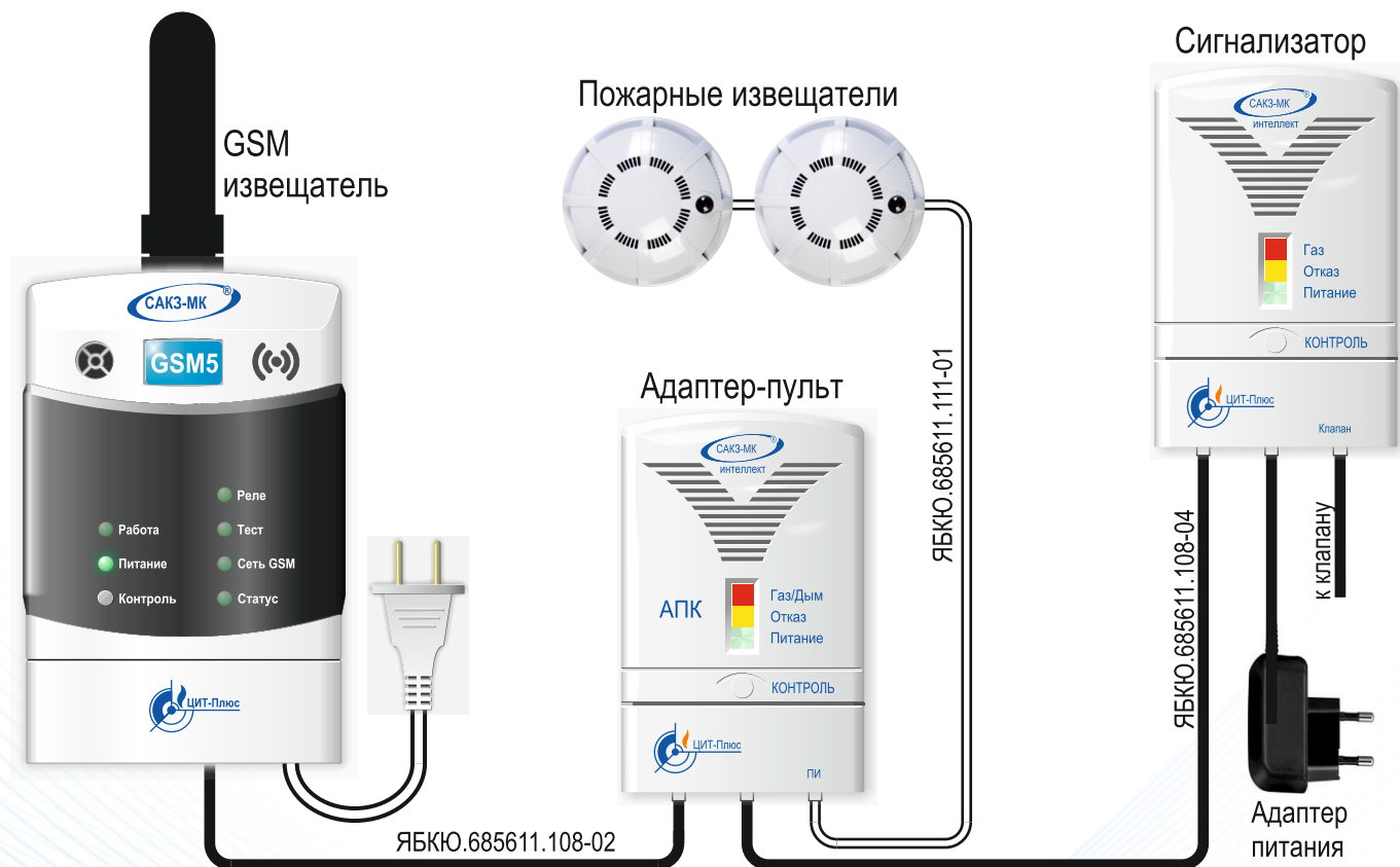
Схема соединений с GSM5-105 и пожарными извещателями
