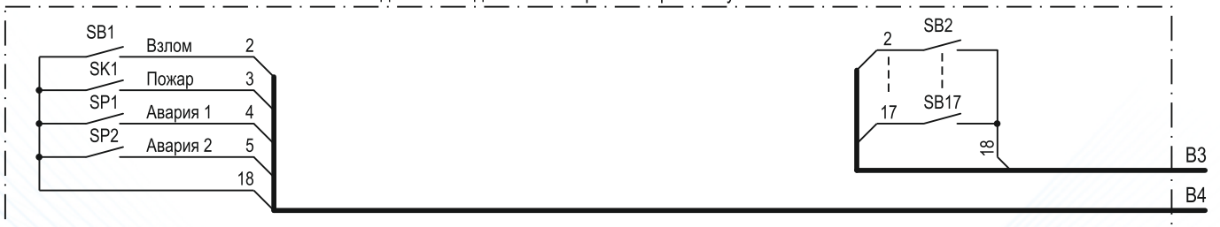
Схема подключения датчиков с нормально разомкнутыми контактами
